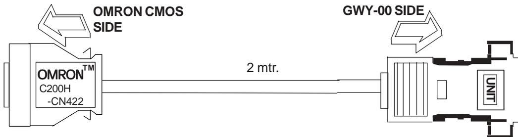
**OMRON 20 PIN CONNECTOR (CMOS)**
