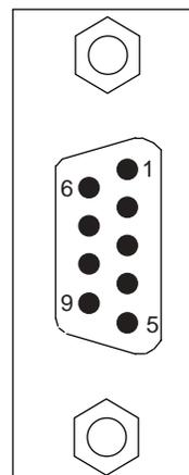
9.6 SIEMENS STEP 7 MICRO (S7-200) PLC TO GWY-S7 (EC-G7-077-00)
